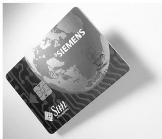
*Die Java Smart Card Spezifikation definiert eine reduzierte Embedded Java Variante für den Einsatz in Kreditkarten. Hier ein Prototyp der Firma Siemens (1998)*
