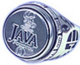
*Der iButton der Firma Dallas Semiconductors (2000) ist eine Embedded Java Hardware-Lösung im Knopf-Format, hier verarbeitet zu einem Ring. Er bietet je nach Ausführung bis zu 64 KByte ROM und 134 KByte RAM für die auszuführende Applikation und verwendet eine stark eingeschränkte JVM.*
